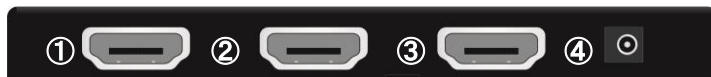
①HDMI 入力端子 ②HDMI 出力端子 1 ③HDMI 出力端子 2 ④電源コネクタ
