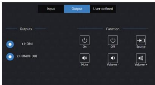
出力端子に接続する機器にCECコマンドの送信設定メニュー 'CEC'>'Output'
