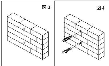
④乾式壁用ネジを用いて、壁面側プレートを壁に取り付けてください。過剰に締め付けないようにご注意ください。
