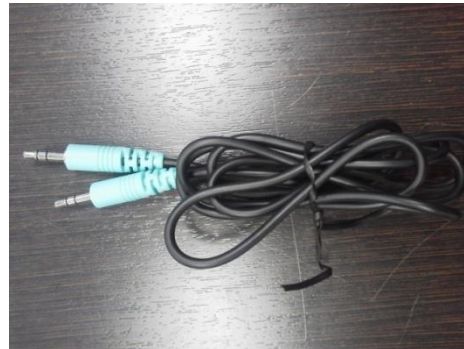
メディアプレイヤー ⇄ ボタンボックス接続ケーブル (有線接続の場合のみ)
